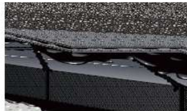
Acabado con elementos pesados (ej.: gravilla)
