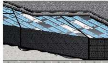
Paneles soldables que se pueden encolar en frío sobre hormigón
