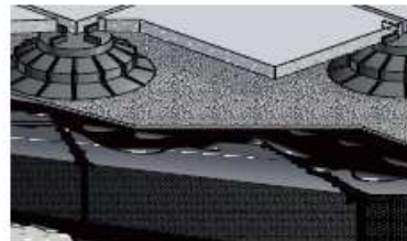
Acabado con losas sobre bases de hormigón
